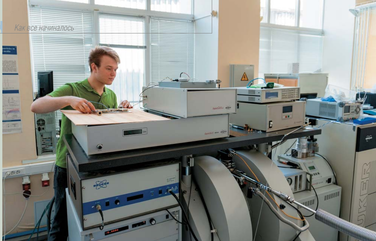
Настройка ЭПР-спектрометра в лаборатории ЭПР-спектроскопии МТЦ СО РАН. 2023 г. Фото из архива МТЦ СО РАН
