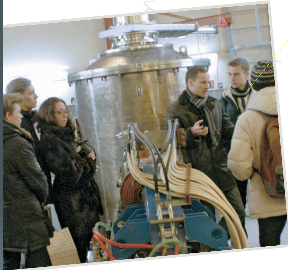
Главная часть установки для БНЗТ – ускоритель нового типа, генерирующий пучок эпитепловых протонов. На фото – сотрудник лаборатории бор-нейтронозахватной терапии Александр Макаров рассказывает о принципах работы уникального ускорителя очередной экскурсии новосибирских школьников
