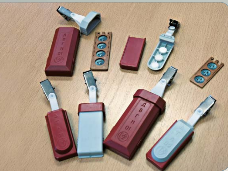
Современные монокристаллические дозиметры производства Ангарского электролизного химического комбината
