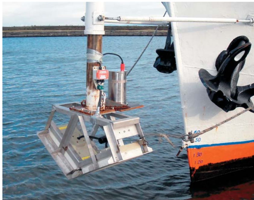
На судне была смонтирована мобильная штанга для прочного крепления погружаемого модуля
