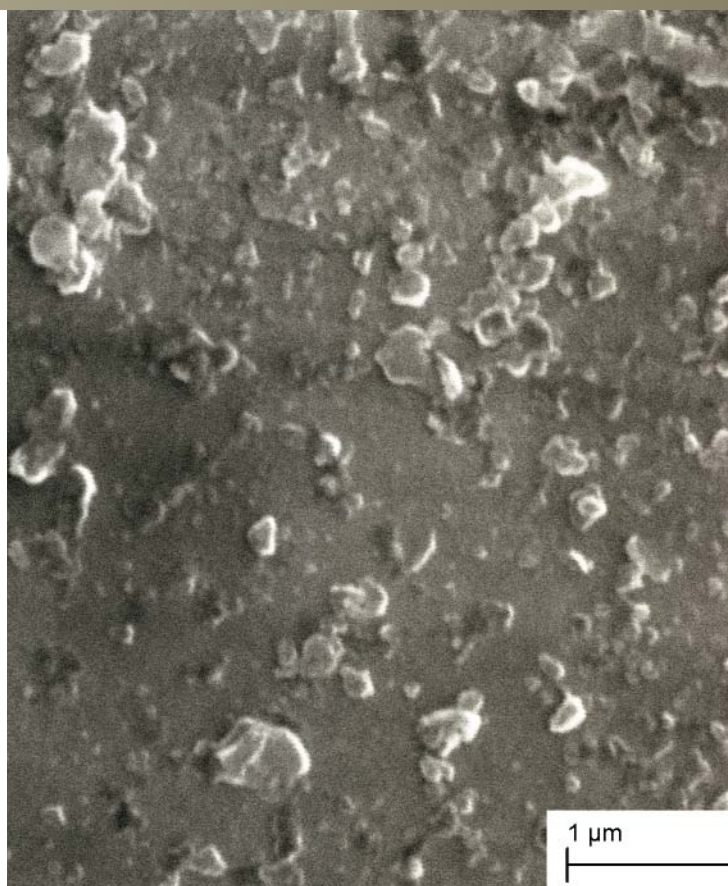
Субмикроструктурные и наноструктурные частицы высокопрочных соединений карбидов ванадия и титана на поверхностях трения «сталь ШХ15–высокохромистый чугун»
