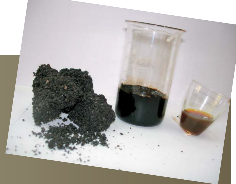
Тяжелая зуунбаянская нефть (слева) и полученная из нее «синтетическая» нефть (справа)
