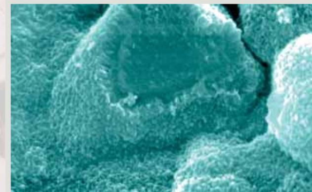
Нанокристаллы цеолита, синтезированные гидротермальным способом на специально подготовленной прочной подложке – микросферическом корунде с уже созданной системой транспортных мезо- и макропор. Электронная микроскопия
