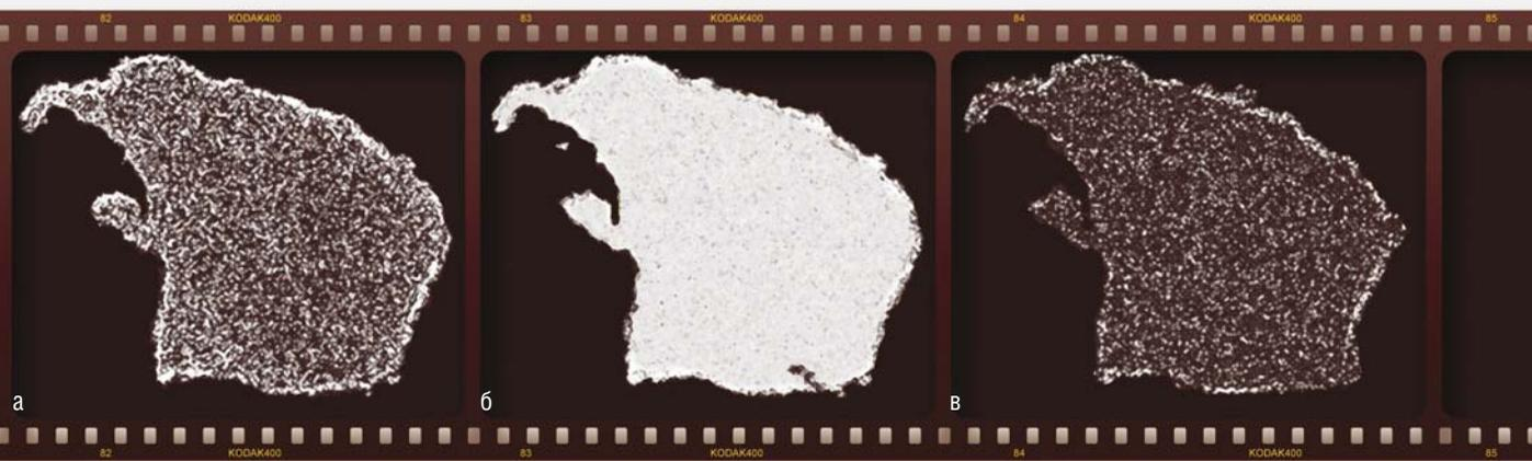
На полированном срезе рудного образца при большом увеличении хорошо видны сростания ютенбогардтита с самородным золотом. Вверху – общий вид кварцевой прожилки с темными вкраплениями рудных минералов. Месторождение Юное (Магаданская обл.)
