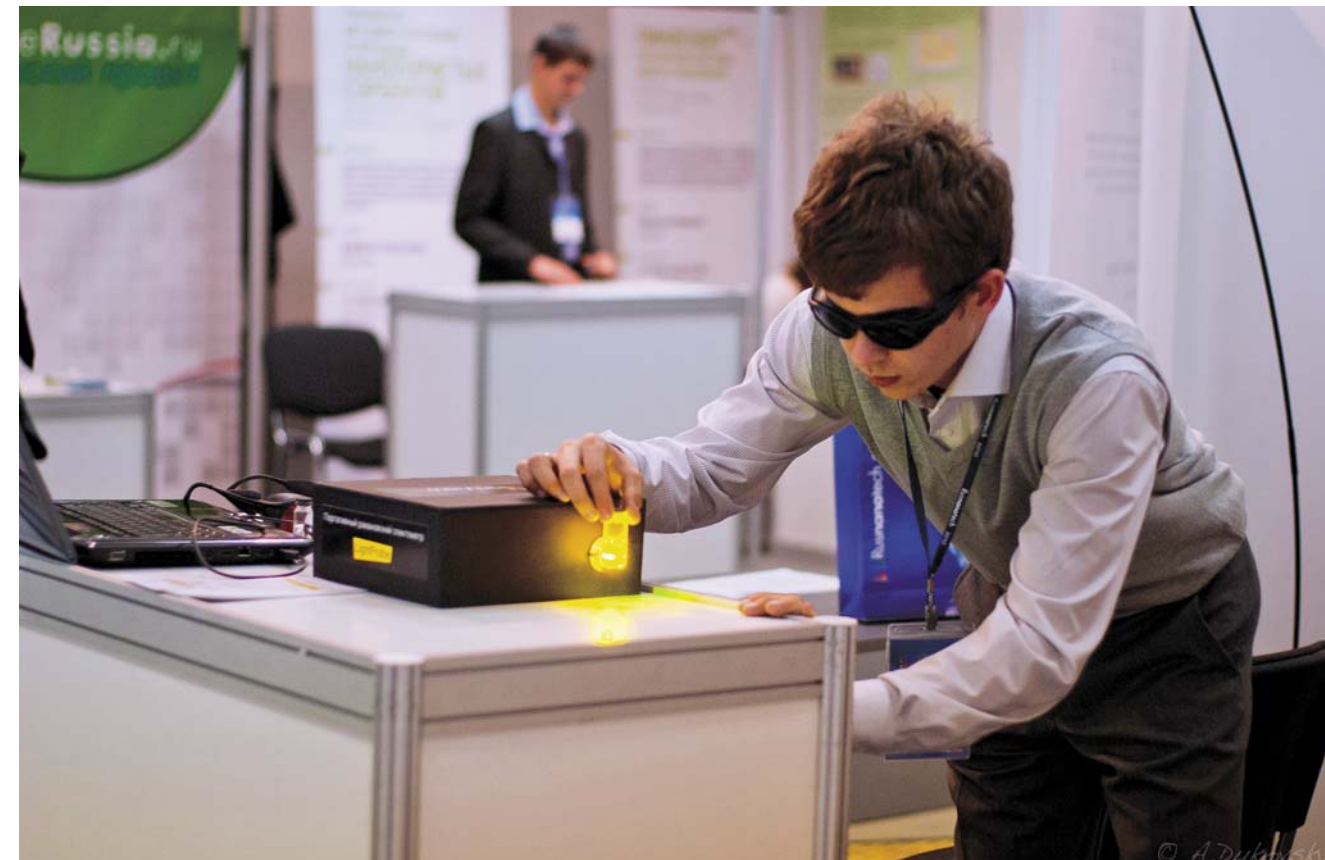
С помощью нового оптического прибора можно быстро и точно определять химический состав вещества даже сквозь упаковку. На фото – Д. А. Гаврилов, один из создателей прибора, демонстрирует его возможности на выставке «РусНаноТех-2010» (Москва)
