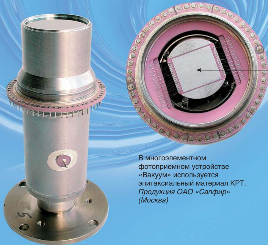
Фотоприемная матрица на основе КРТ
