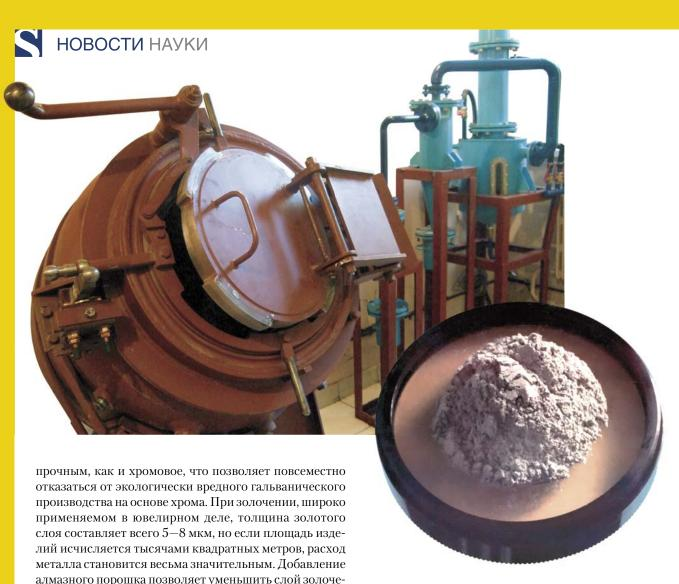
В лабораторной установке ИПХЭТ СО РАН изучают процесс детонационного синтеза наноматериалов. Внешняя крышка камеры выдерживает давление в десятки атмосфер. Справа – полученная этим методом наноалмазная пудра марки УДА-П
