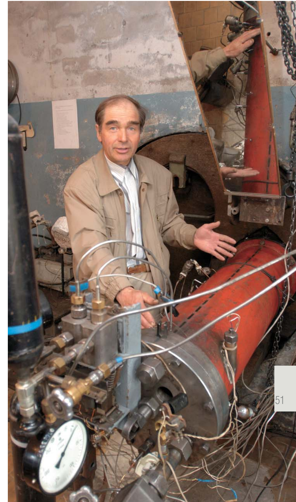
Чем меньше размер камеры сгорания, оптимальный для эффективного детонационного сжигания топливно-воздушной смеси, тем компактней и энергетически выгодней двигатель
