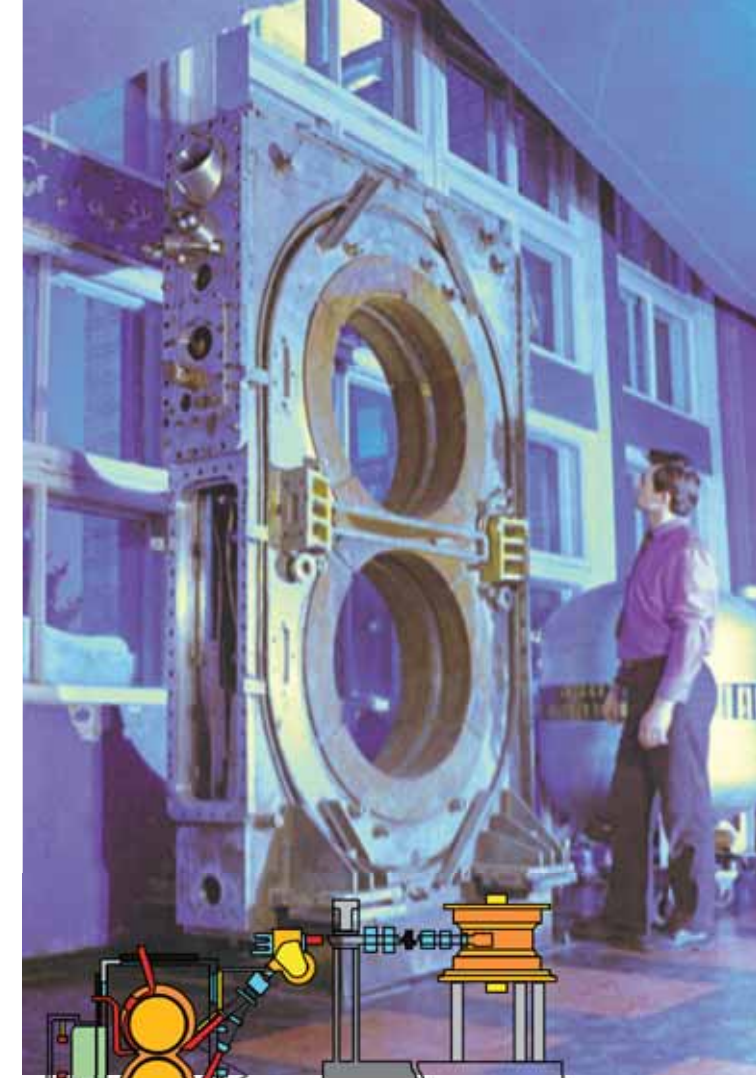
ВЭП-1 — первая экспериментальная установка ИЯФ СО РАН со встречными электронными пучками с энергией 2 \times 160 МэВ
