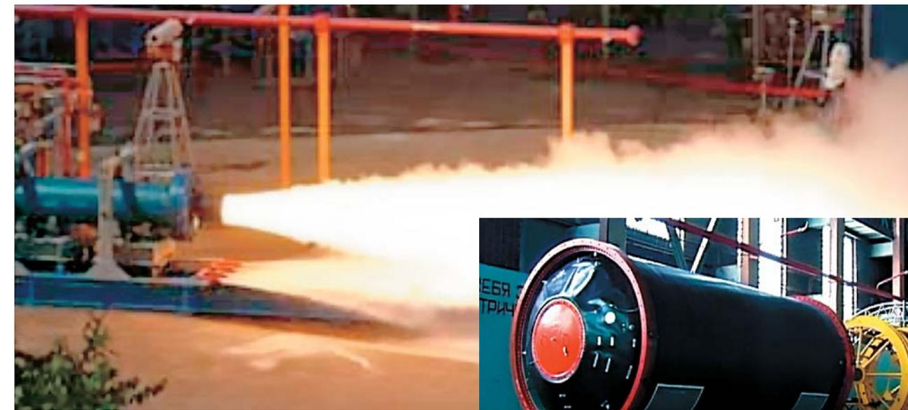
Наземное стендовое испытание ракетного двигателя позволяет замерить его рабочие энергетические характеристики для определения их соответствия проектно-расчетным значениям и подтвердить его гарантированную надежность, в том числе с помощью имитации запредельных нагрузок и воздействий
