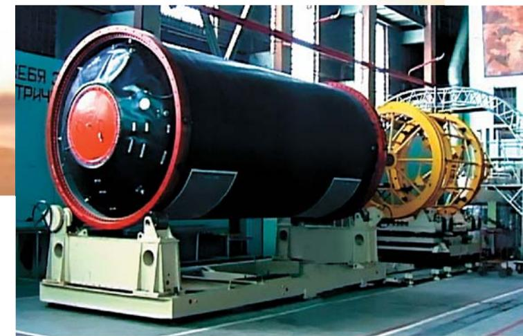
Подготовка к снаряжению корпуса первой ступени твердотопливной межконтинентальной баллистической ракеты, принятой на вооружение. Вес монозаряда – 45 тонн
