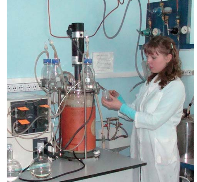
В автоматизированном ферментационном комплексе в выращиваются бактерии в режиме синтеза ПГА нового типа — резиноподобного сополимера
