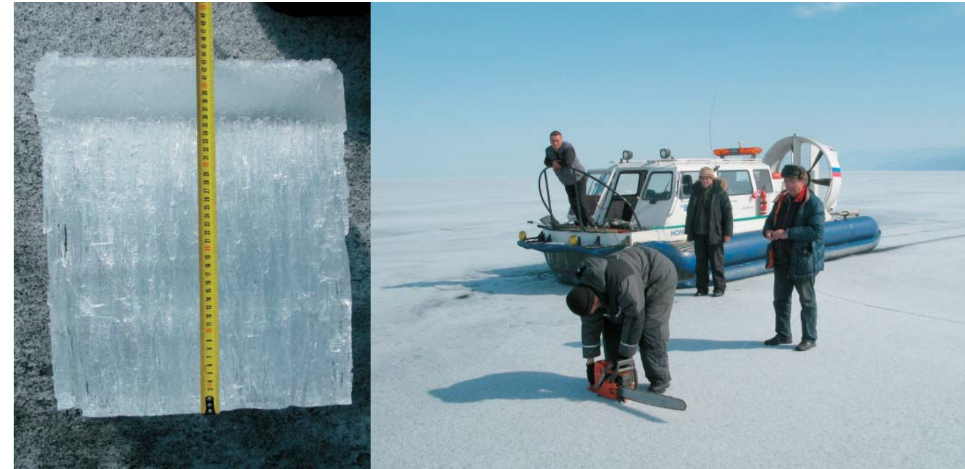
Для обследования льда ученые использовали катер на воздушной подушке «Хиус». Ледовый керн, взятый на расстоянии 2 км от центра кольцевой структуры, оказался весь пронизан микротрещинами. Апрель 2009 г.
