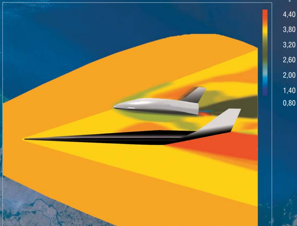
Теоретическое распределение чисел Маха (скоростей) при обтекании двухступенчатой конфигурации ELAC–EOS (число Маха набегающего потока M = 4,04 ). По: (Брейтсамтер и др., 2005)
