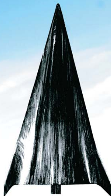
Маслосажевая картина линий тока на поверхности модели ELAC 1, полученная в аэродинамической трубе Т-313 Института теоретической и прикладной механики СО РАН. По: (Krause et al., 1999)
