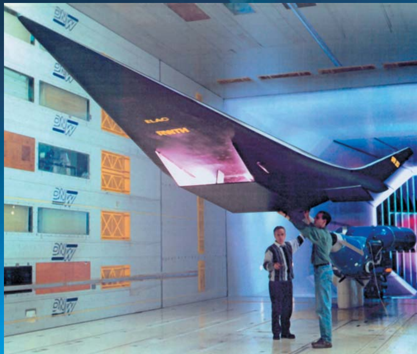
Большая модель ELAC 1 (длиной более 6 м) в рабочей части германско-голландской аэродинамической трубы DNW малых скоростей. По: (Рейбл, Якобс, 2005)
