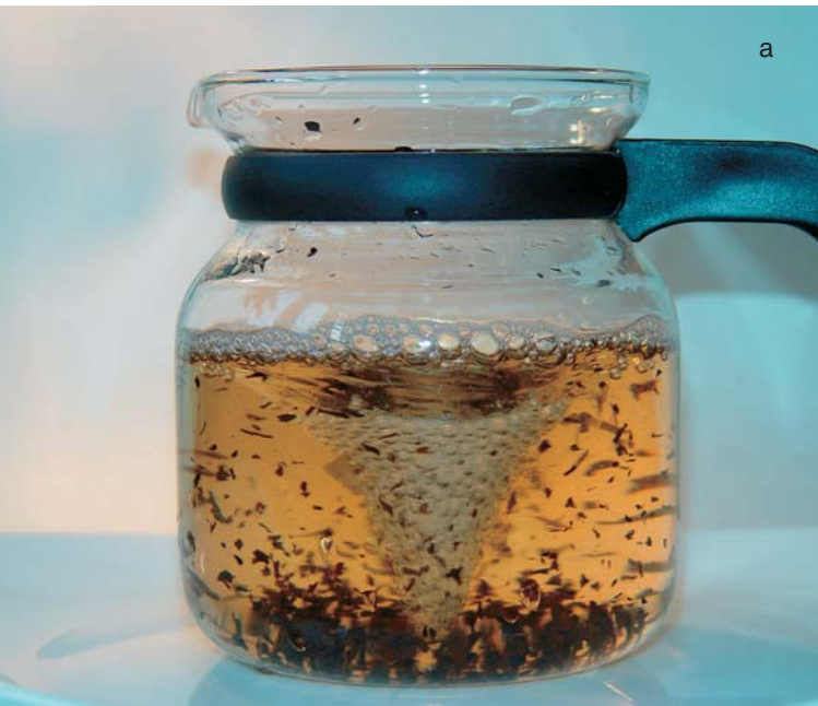
Эффект Эйнштейна в стакане с сильно раскрученной жидкостью с чайниками. Образование воронки: легкая фракция — воздух (внутри воронки); тяжелая — чайники (вне воронки) (а). Затухание вихревого течения: чайники устремляются к оси цилиндрического стакана, а легкая фракция (воздух) поднимается вверх (б)
