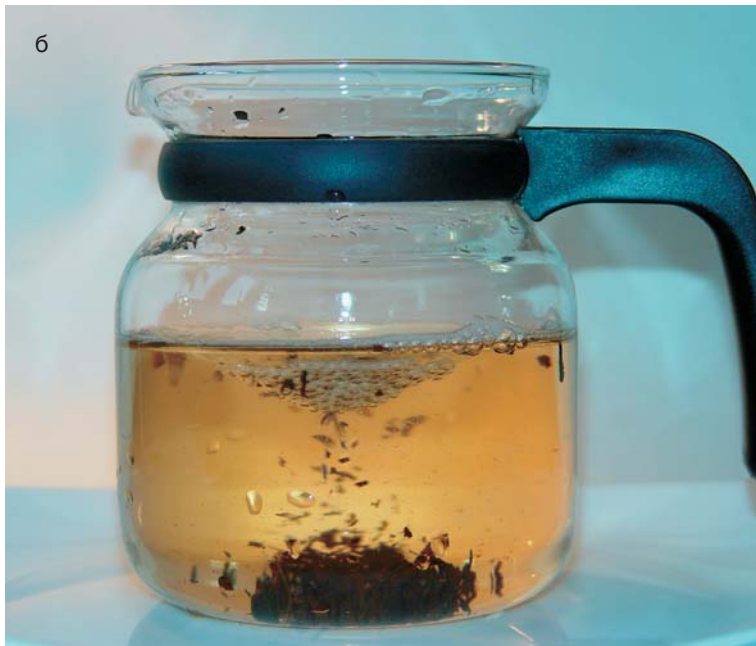
Эффект Эйнштейна в стакане с сильно раскрученной жидкостью с чайниками. Образование воронки: легкая фракция — воздух (внутри воронки); тяжелая — чайники (вне воронки) (а). Затухание вихревого течения: чайники устремляются к оси цилиндрического стакана, а легкая фракция (воздух) поднимается вверх (б)
