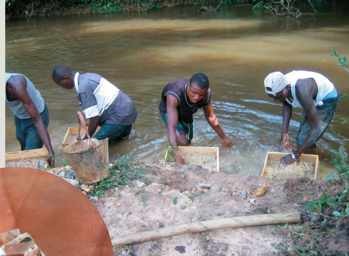
Для промывки алмазоносных отложений используют квадратные сита с мелкой сеткой, а осадок затем внимательно осматривают. На такой импровизированной обогатительной фабричке в Гвинеи был найден и этот алмаз весом 2,5 карата (фото слева). На фото внизу справа – автор
