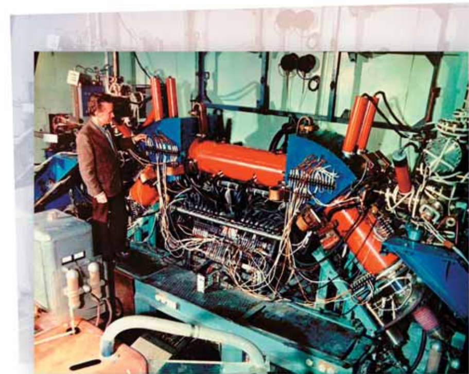
1976 год. Сердце комплекса НАП-М – реализующая метод электронного охлаждения установка ЭПОХА (установка с Электронным Пучком для ОХлаждения Антипротонов). На снимке – один из ее создателей В. И. Куделайнен
