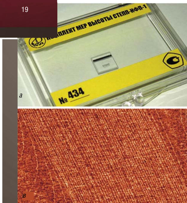
Комплект мер высоты СТЕПП-ИФП-1 (а) и фазовое АСМ-изображение поверхности кремния (в), содержащей 58 ступеней, которое соответствует спектру высот от 0 до 18,21 нм (б)
