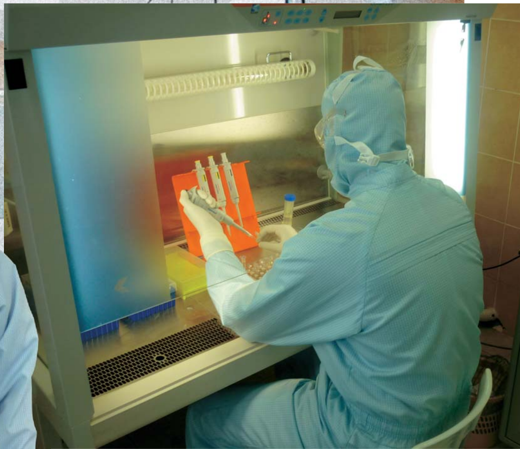
К палеогенетической лаборатории предъявляются гораздо более строгие требования, чем к обычной: высокая степень очистки воздуха, стерильное оборудование, которое не может быть использовано для других работ, специальная экипировка сотрудников, сверхчистые боксы, а также соблюдение специальных мер, предотвращающих загрязнение материала при сборе, хранении, доставке и подготовке к анализу. На фото: А. С. Пилипенко в палеогенетической лаборатории ИЦиГ СО РАН. Новосибирский Академгородок
