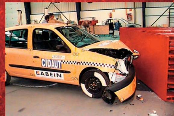
Использование эффекта, показанного на верхнем рисунке, при разработке устройства для обеспечения безопасного торможения автомобиля при ударе: натуральный эксперимент на машине Рено-Клио, Европейский исследовательский центр «Лабейн» (Испания), 1999
