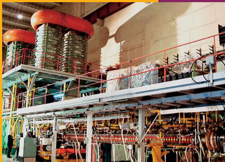
На открытой магнитной системе — многопробочной ловушке ГОЛ-3 в Институте ядерной физики СО РАН — недавно была получена электронная температура 2 кэВ. Для сравнения: на установке 2XIIВ (США) максимальная электронная температура достигала всего 280 эВ
