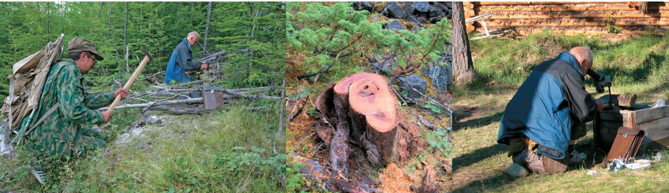
С помощью геологических молотков участники экспедиции отбирают пробы горных пород
